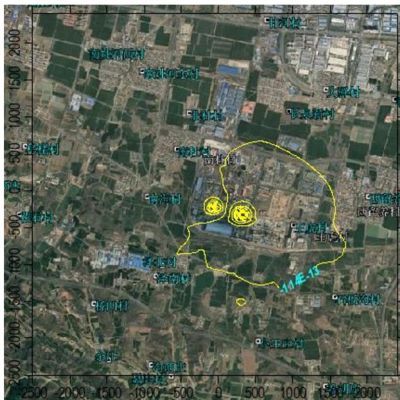
图 7.1-18 预测范围内苯并芘年均浓度叠加值分布图 ( $\text{mg}/\text{m}^3$ )
