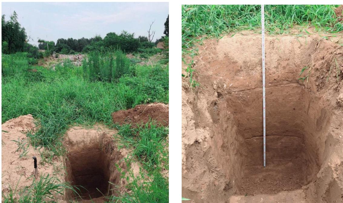
图 5.3-2 土体构型（土壤剖面）
