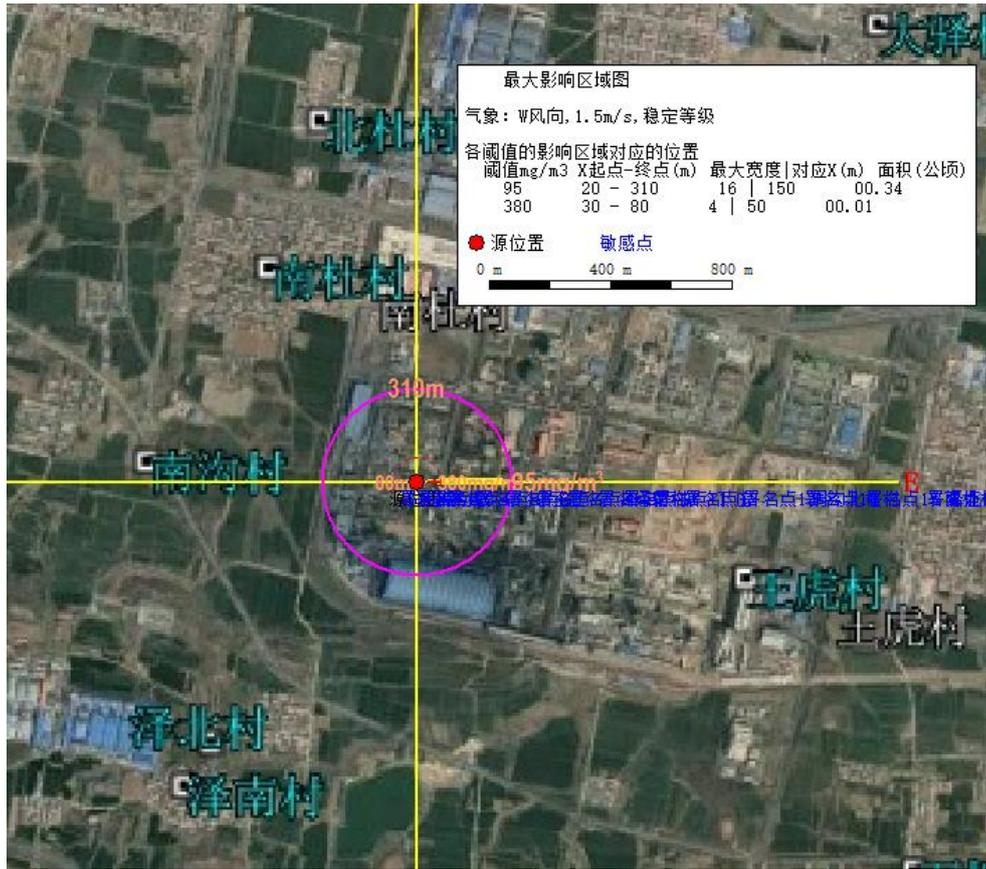
图 9.8-1 (1) (最不利) 荒煤气泄漏事故 (CO) 最大影响范围示意图
